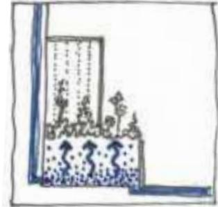
■ *■* **Un système de gouttières ou de «rain chain» qui permet d'irriguer les bacs avec les eaux de pluie**
